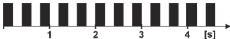
Anzeige der Überschreitung der zulässigen Temperatur im Inneren des Sensors. Die Sensorleistung blockiert, bis der Fehler behoben ist (Abkühlen des Geräts).
